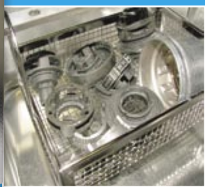
Obr. č. 1: Príklad konštrukcie digitálnej ultrazvukovej čističky a súčiastok pred čistením
