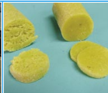
Obr. č. 6: Porovnanie štruktúry rezu – klasický nôž / ultrazvukový nôž.
