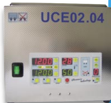
Obr. č. 1: Príklad konštrukcie digitálnej ultrazvukovej čističky a súčiastok pred čistením
